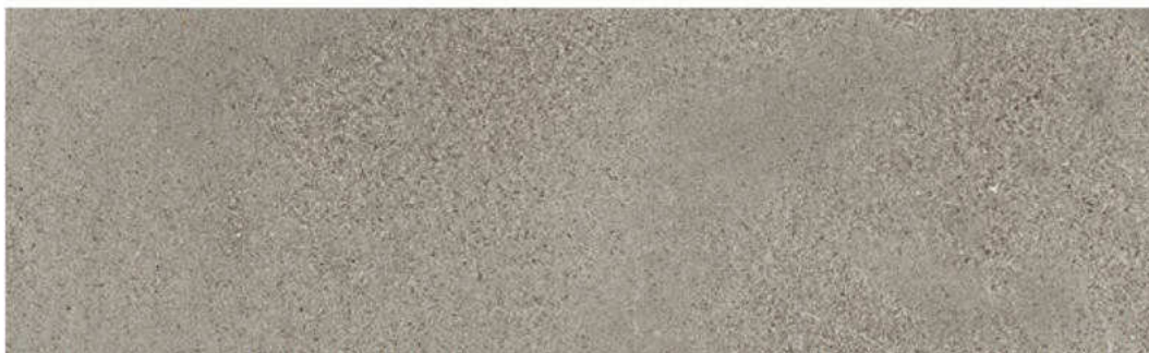
Tierrfino LEHM-BETON-LOOK 2 maliger gleich- mäßiger Auftrag. Oberfläche 2x mit Tierrfino soap (mit 50% Wasser verdünnt) versiegelt.
