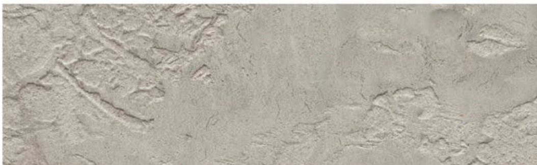
Tierrfino LEHM-BETON-LOOK 3 maliger Auftrag mit grober Struktur. Oberfläche mit Tierrfino wax versiegelt (wax mit 50% Wasseranteil verdünnt).
