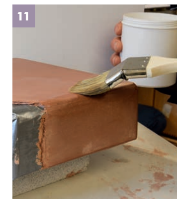
11 Kleinfächiges Auftragen der verdünnten STONE Seife (1 Teil Tierrfino soap in 45 Teile Wasser), die unmittelbar danach mit einem Polierstein, z. B. Achatstein, eingerieben werden muss. Seifenspritzer oder -läufer müssen sofort einmassiert werden, da diese sonst dauerhaft sichtbar bleiben. Dieser Vorgang wird je nach Anwendungsgebiet mehrmals wiederholt (4 - 7 mal). Bei jedem neuen Einmassieren der Seife ist die Konzentration der Seife zu erhöhen (bis zum Schluss auf 1 Teil Tierrfino soap in 15 Teile Wasser).
