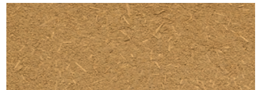
Lehmunterputz trocken, gerieben
